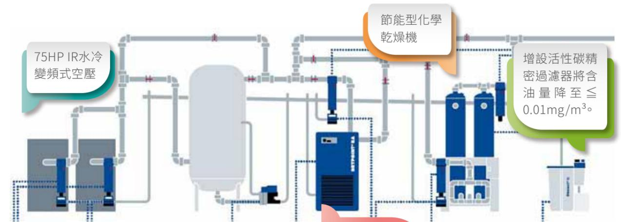
75HP IR 水冷變頻式空壓機
